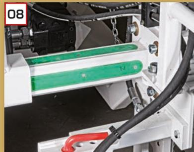
08 Hydraulisch ausfahrbarer Bohlen-träger zur Einbaupositionierung
