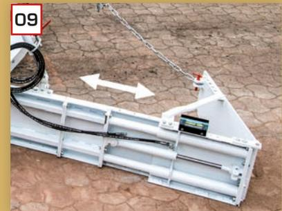
09 Hydraulisch ausfahrbare Einbaubohe mit einer Standard-Arbeitsbreite von 500–2.000 mm (optional 500–3.000 mm)
