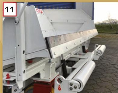
11 Hydraulische Neigungsverstellung der Bunkerklappe
