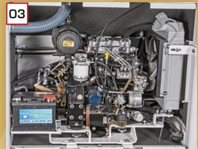
Leistungsstarker, wassergekühlter und geräuschreduzierter 3-Zylinder Kubota-Dieselmotor
