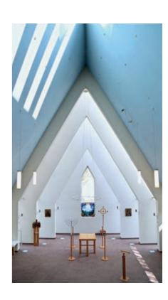
Die Lichtgestaltung mit Fensterbändern in Fassade und Dach sowie einem Beleuchtungskonzept mit vielfältigen Lichtszenen prägt den emotionalen Raumeindruck. Im Kirchenraum befindet sich ein begehbares Taufbecken für Ganzkörpertaufen.
