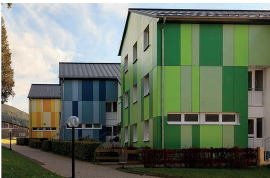
Das Ensemble wurde 1973 als Flachdachbau errichtet. In den 80er Jahren wurden aus konstruktiven Gründen Satteldächer aufgesetzt.
